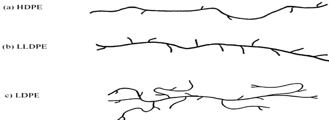
Figure I-9 Ramification générale des structures de polyéthylène : a) haute densité (HDPE); b) basse densité linéaire (LLDPE); c) basse densité (LDPE) (Tiré de Cheng 2008).
