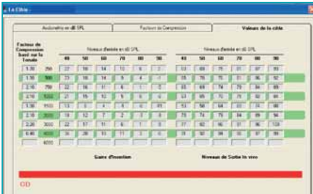
FIGURE 11 : VALEUR DES GAINS CIBLE (GAIN D'INSERTION) POUR UN NIVEAU DE SIGNAL D'ENTRÉE DE 70 DB SPL VALUE OF THE TARGET GAINS (INSERTION GAIN) FOR AN INPUT SIGNAL LEVEL OF 70 DB SPL
