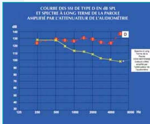
FIGURE 18 : COURBE DES SSI DE TYPE D EN DB SPL ET SPECTRE À LONG TERME DE LA PAROLE AMPLIFIÉ PAR L'ATTÉNUATEUR DE L'AUDIOMÈTRE. DANS LE CAS D'UNE COURBE DES SSI DE TYPE D, LE MAXIMUM ACCEPTABLE VOCAL EST OCCASIONNÉ PAR LES SEULES FRÉQUENCES GRAVES. IL S'AGIT DU CAS LE PLUS FRÉQUENT, CORRESPONDANT AUX COURBES DE SSI DE TYPE C ET D. À L'INVERSE, LA COURBE DES SSI DE TYPE A, POUR LAQUELLE LE M.A.V. EST OCCASIONNÉ PAR LES SEULES FRÉQUENCES AIGÜES, EST TRÈS PEU COURANT.
