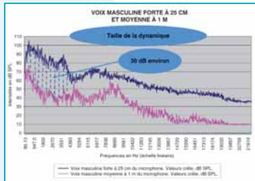
FIGURE 9 : TAILLE DE LA DYNAMIQUE ENTRE LES SPECTRES MOYENS À LONG TERME DE LA PAROLE, EN VALEURS CRÊTE, POUR UNE VOIX MASCULINE FORTE À VINGT-CINQ CENTIMÈTRES ET MOYENNE À UN MÈTRE. MATÉRIEL VOCAL : LISTE 1 DES PHRASES DE COMBESCURÉ. ÉCHELLE LINÉAIRE DE FRÉQUENCES DE 86 À 21 619 Hz. ÉCHELLE DES AMPLITUDES EN DB SPL. SIZE OF THE DYNAMIC RANGES BETWEEN THE AVERAGE LONG-TERM SPEECH SPECTRA, IN PEAK VALUES, FOR A LOUD MALE VOICE AT 25CM AND THE AVERAGE AT 1M. SPEECH EQUIPMENT: LIST 1 OF COMBESCURÉ'S PHRASES. LINEAR SCALE OF FREQUENCIES FROM 86 TO 21,619 Hz. SCALE OF AMPLITUDES IN DB SPL.
