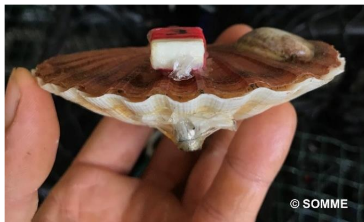
Figure 12 : Coquille Saint-Jacques équipée d'un accéléromètre/valvomètre.
