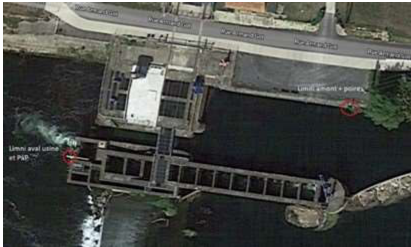
Figure 9. Limnimètres pour mesures des niveaux d'eau amont et aval à Bergerac – Donnée GU
