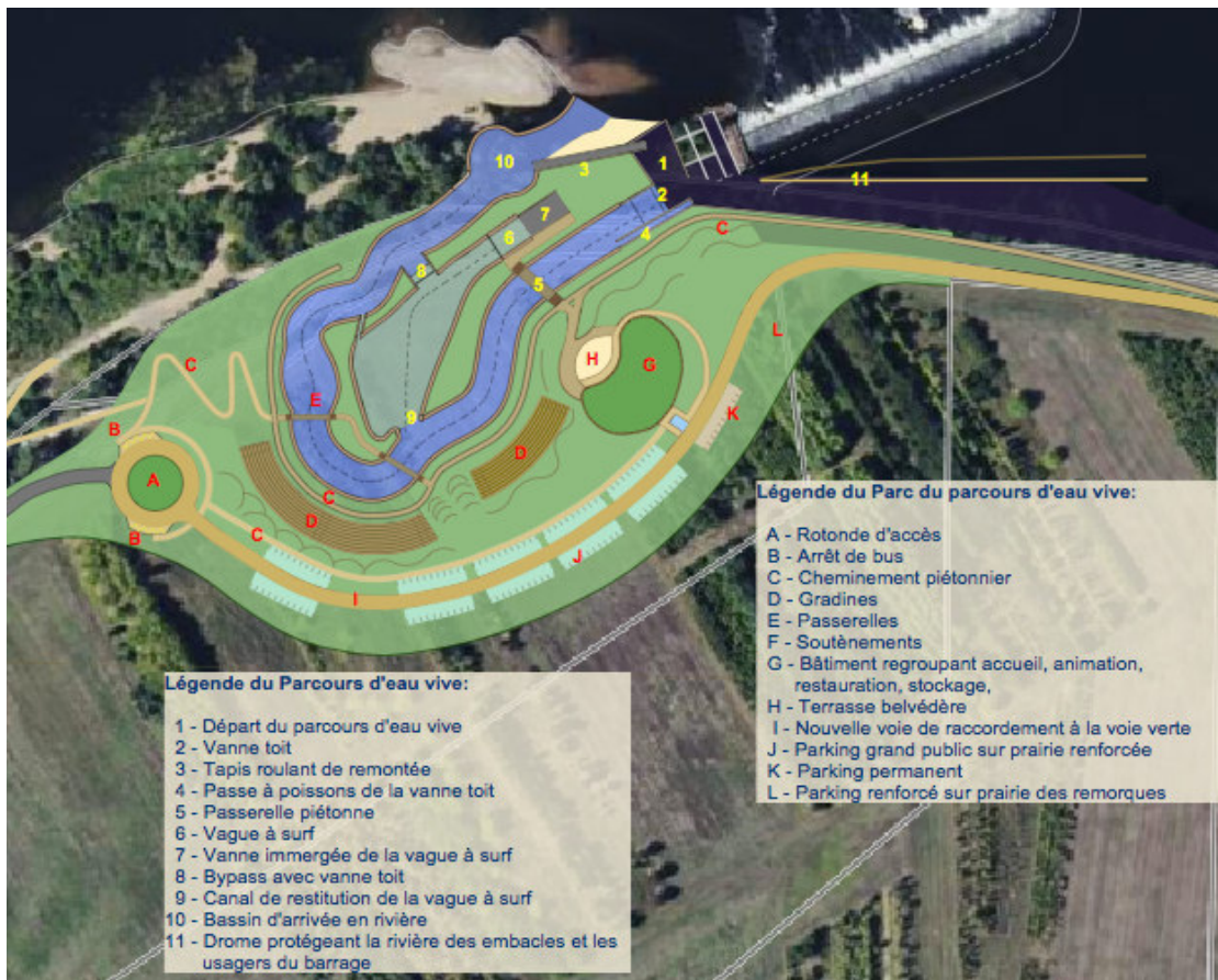
Figure n°47 Schéma fonctionnel du parc de la rivière d'eau vive
