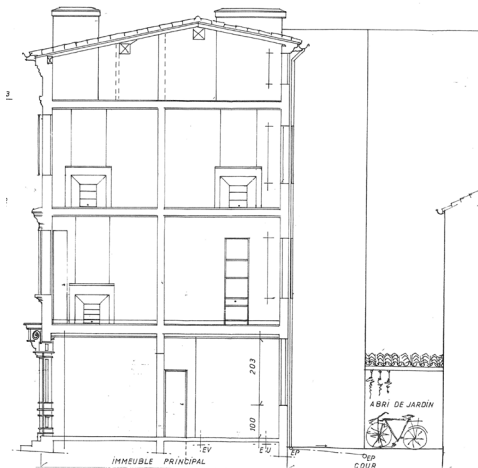
Etat après travaux : rdc transformé en boutique, transformation de la façade. Cour dégagée, évolution de sa géométrie.
