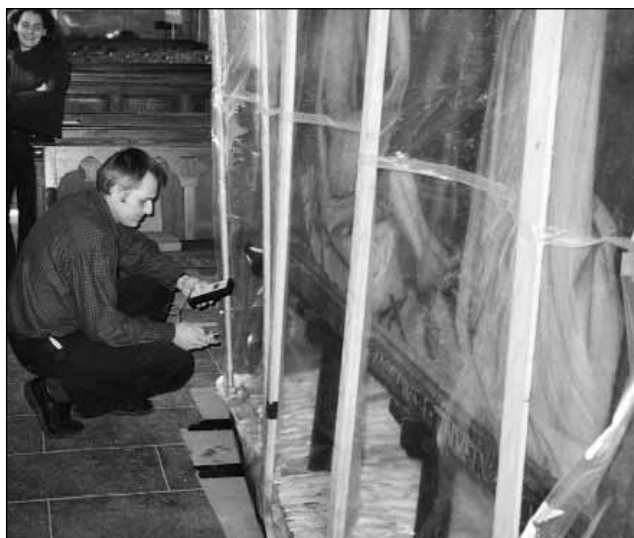
Mesure du taux d'oxygène résiduel dans l'enveloppe pour s'assurer du respect des conditions du traitement en anoxie.
