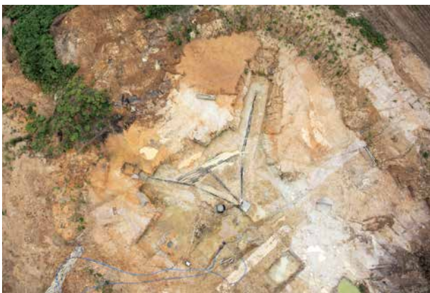
Vue aérienne du système de captage de source constitué de conduites rayonnantes en chêne. © Com'Air
