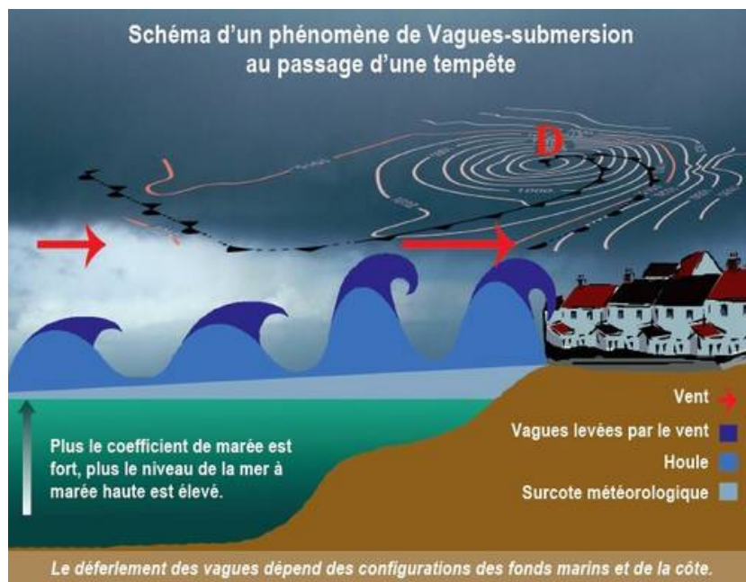
Figure 1.1.2: Schéma d'un phénomènes de vagues-submersion au passage d'une tempête- Source : Météo France
