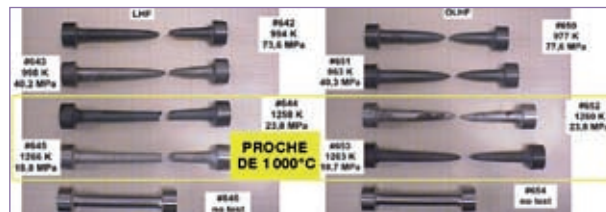
Figure 2 Essais de caractérisation sur les matériaux de cuve LHF/OLHF.
