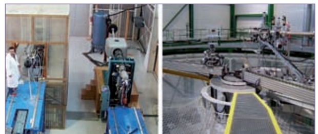
Figure 6 Accélérateurs dédiés à la production de champs de neutrons « monoénergétiques ». Sur la photo de gauche : J25 (à gauche) et T400 (à droite). Sur la photo de droite : bout de ligne de l'accélérateur AMANDE et mesure de la fluence des neutrons diffusés avec le long compteur de l'IRSN et un cône d'ombre (13) .
