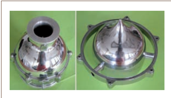
Figure 2 Photographies d'une tête de prélèvement typique, à gauche la tête de prélèvement, à droite le bulbe contenant le détecteur nucléaire.
