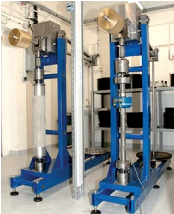
Figure 2 Bâti de fluage en traction.
