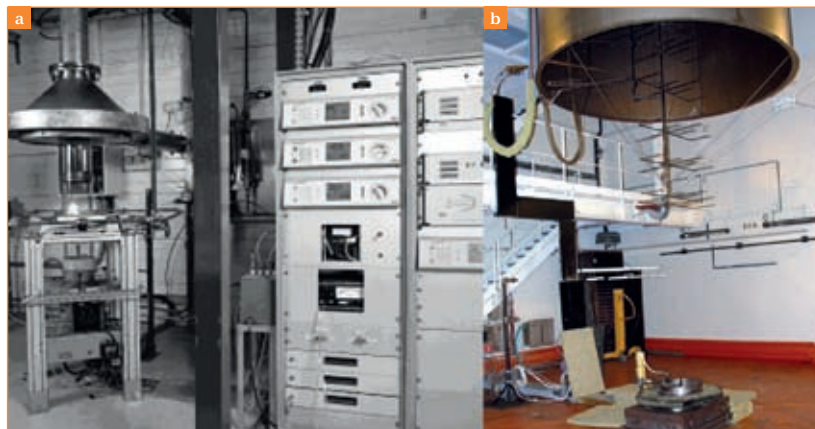
Figure 2 a) Calorimètre de Tewardson à petite échelle (Ineris) (bac de l'ordre de 10 cm de diamètre). b) Calorimètre à grande échelle (IRSIN) (bac de l'ordre de 1 m de diamètre).
