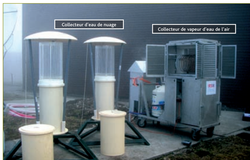
Figure 2 Collecteurs de vapeur d'eau de l'air et d'eau de nuage.
