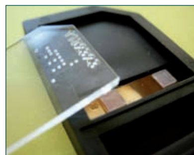
Figure 2 Le PN3+ de l'IRSN, un dosimètre plus sensible, doté de fonctions d'expertise et adapté aux spectres neutroniques rencontrés habituellement dans l'industrie nucléaire ou le secteur médical.
