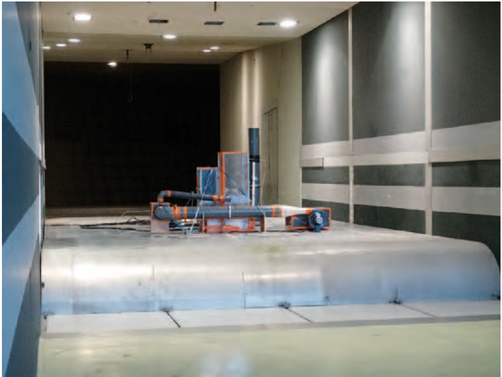
Figure 1: Vue de la maquette du réseau de ventilation d'une installation nucléaire simplifiée placée dans la soufflerie climatique Jules Verne du CSTB de Nantes. (Configuration 1)
