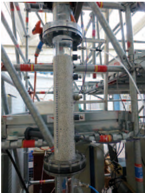
La section d'essai de l'installation CALIDE contenant un lit de débris
