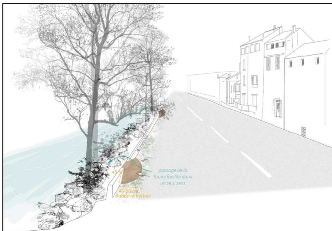
Schéma de principe des tremplins terreux (© TEREO)
