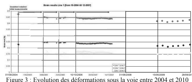
Figure 3 : Evolution des déformations sous la voie entre 2004 et 2010
