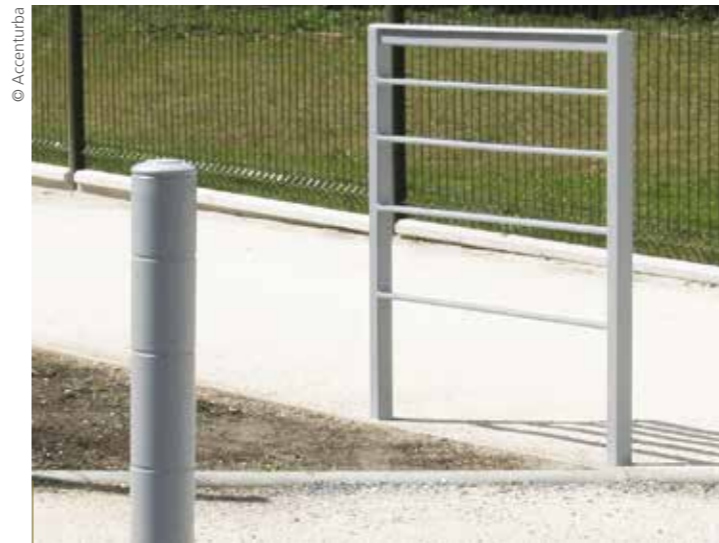
Proposés par Accenturba, les potelets Luz ont un diamètre de 90 mm. Ils sont composés d'acier de 3 mm d'épaisseur, grenailé, zingué et peint (poudre polyester cuite au four).
