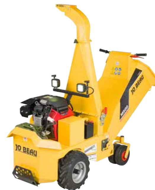
Alimenté par un moteur Honda de 24 cv, le M500 est un broyeur compact de 730 mm de large, avec une grande trémie de chargement de 660 x 530 mm, rabattable pour la maintenance et la compacité. Sa capacité de coupe de 120 mm.
