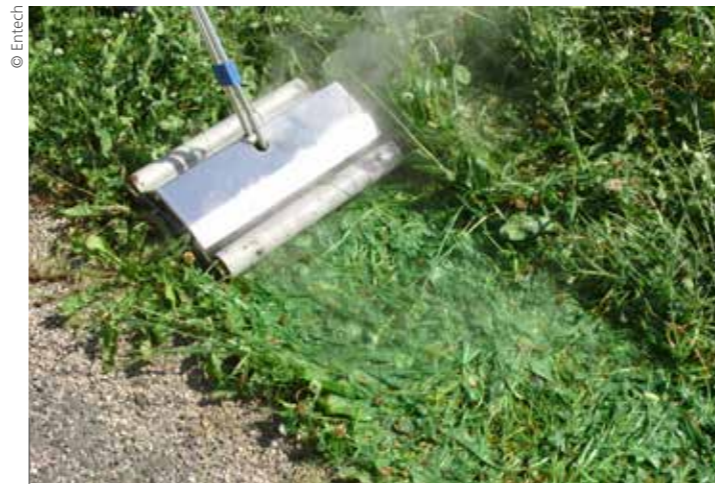
Avec un désherbeur à eau chaude, la pression de travail doit être réglée aux alentours de 15 et 20 bars, de façon à injecter la vapeur dans le sol pour atteindre le système racinaire et les graines dans les premiers centimètres du sol.
