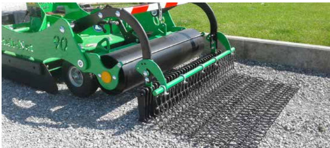
Les pièces d'usure en acier spécial sont auto-affûtantes et conçues pour le désherbage, l'entretien et le curatif. Elles peuvent être changées une à deux fois par an (coût : de 190 à 280 €/HT/an), pour 8 à 20 ha de surfaces désherbées, soit un coût de remplacement inférieur à 0,01 €/m².
