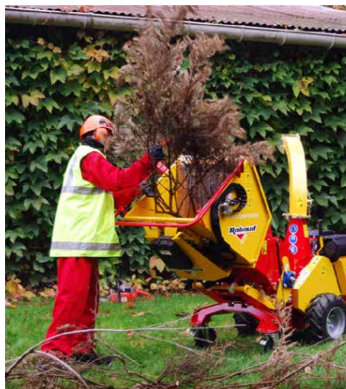
Equipé du rotor '5 en 1', le broyeur Xylochip 100 DA de Rabaud possède un rouleau d'alimentation, large de 406 mm et réglé électroniquement, à pas convergent, afin de mieux centrer les branches et de faciliter l'acceptation des bois fourchus.
