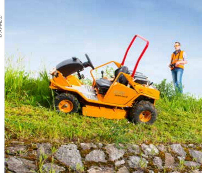
Avec la tondeuse-débroussailleuse Sherpa 940 4WD RC d'As-Motor, l'opérateur adapte son comportement en fonction du site (présence d'obstacles, pentes...) : soit il monte à bord, soit il pilote la machine à distance à l'aide d'une télécommande.
