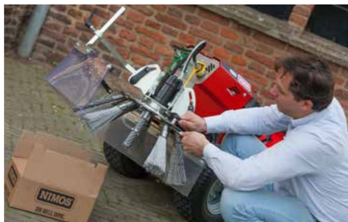
Le choix d'une brosse (brins mixtes, 100 % métalliques...) dépend de la nature du sol et de l'abondance des adventices. Le passage d'une brosse à une autre s'effectue à l'aide de simples écrous.
