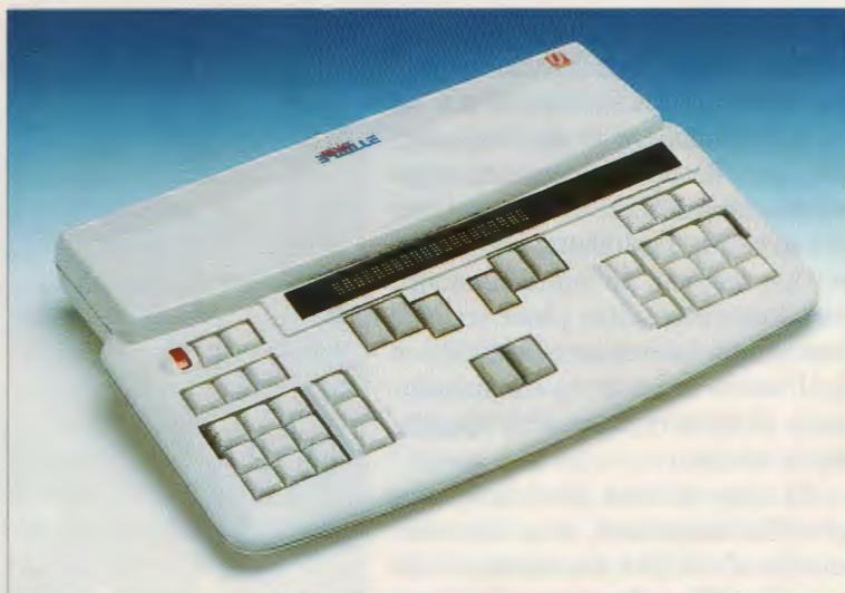
Figure 5 - Bloc-notes portable autonome Visiobric (mémoire 256 ko). Peut être utilisé comme périphérique d'ordinateur (émulation du clavier, sortie sur barrette tactile ou par synthèse vocale).
