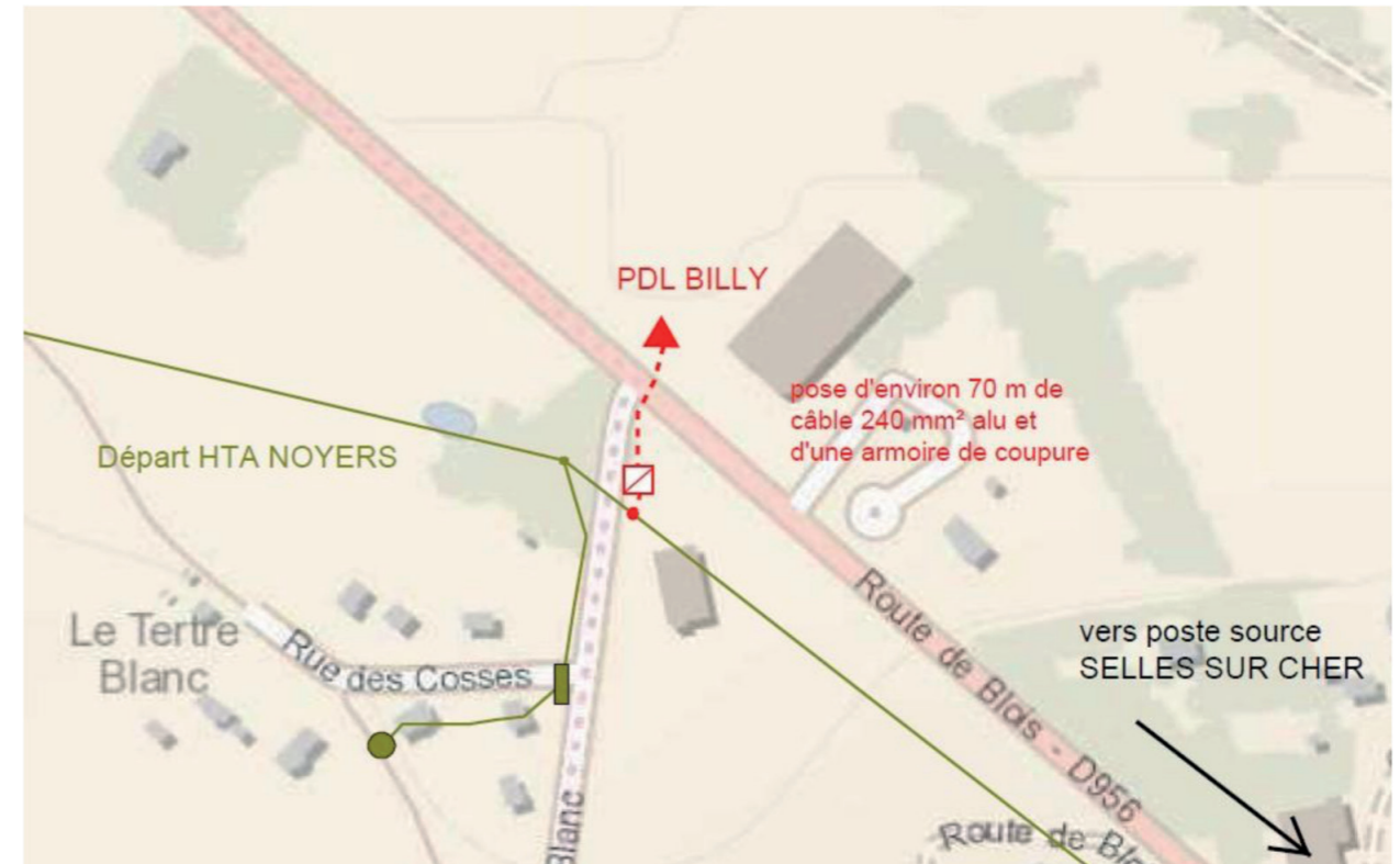
LOCALISATION DU RACCORDEMENT
