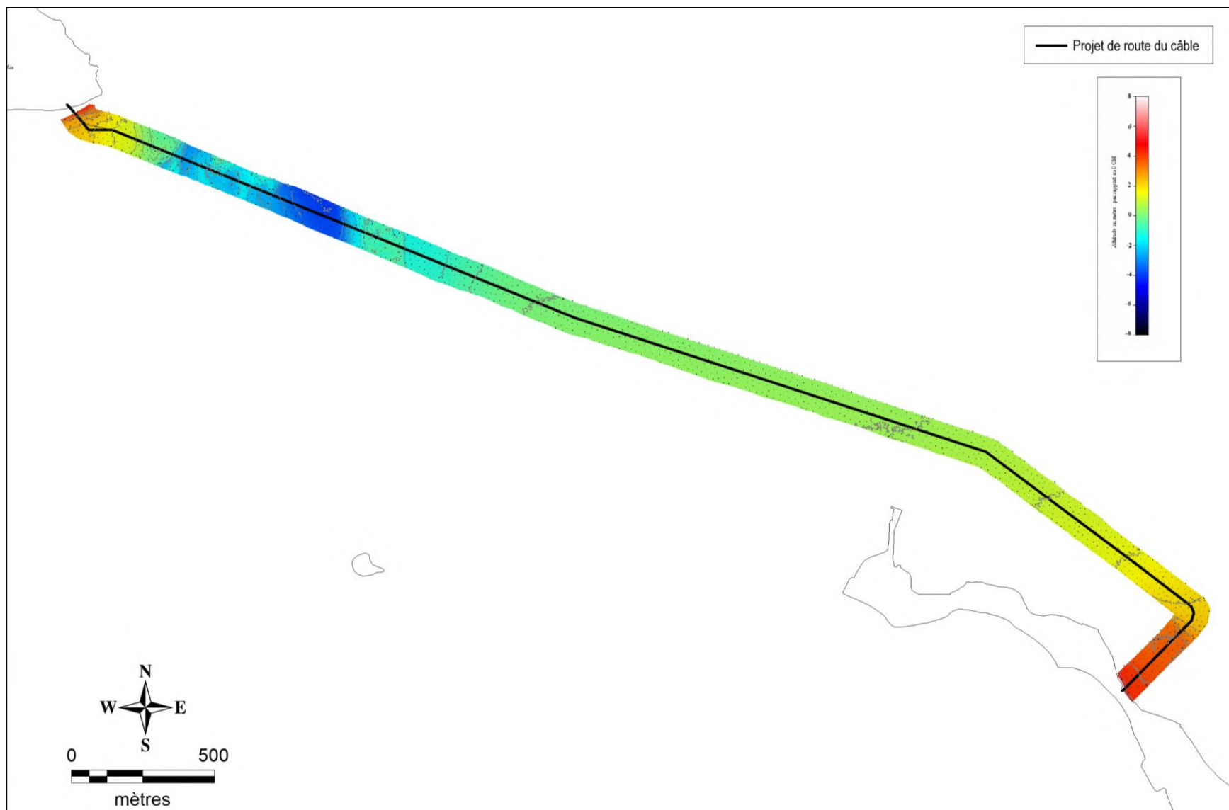
Figure 5 : Bathymétrie sur le projet de route du câble sous-marin (Mesuris 2020)
