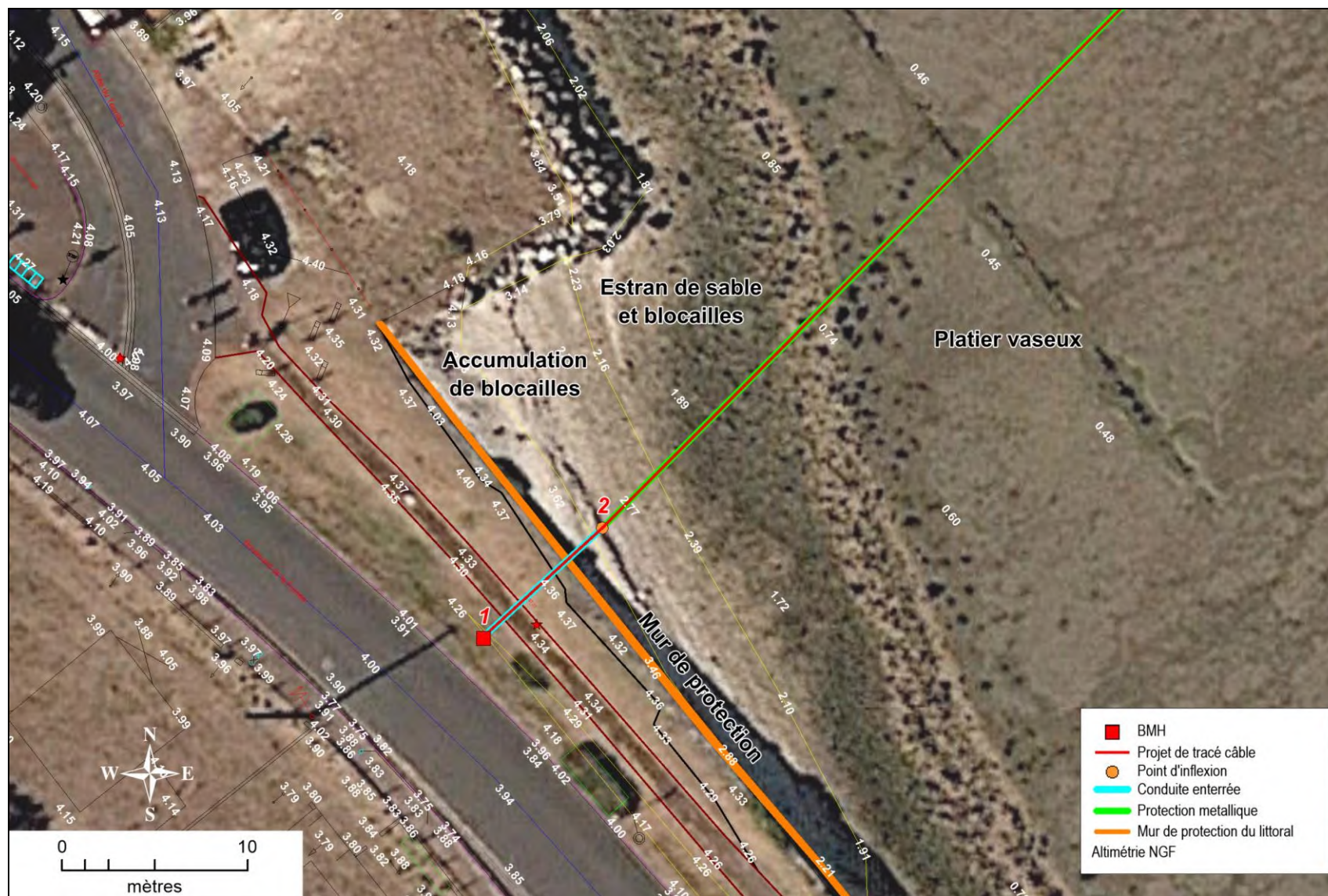
Figure 21 : Détail du projet sur la plage - atterrage de Fouras image (Drone33 mai 2020)
