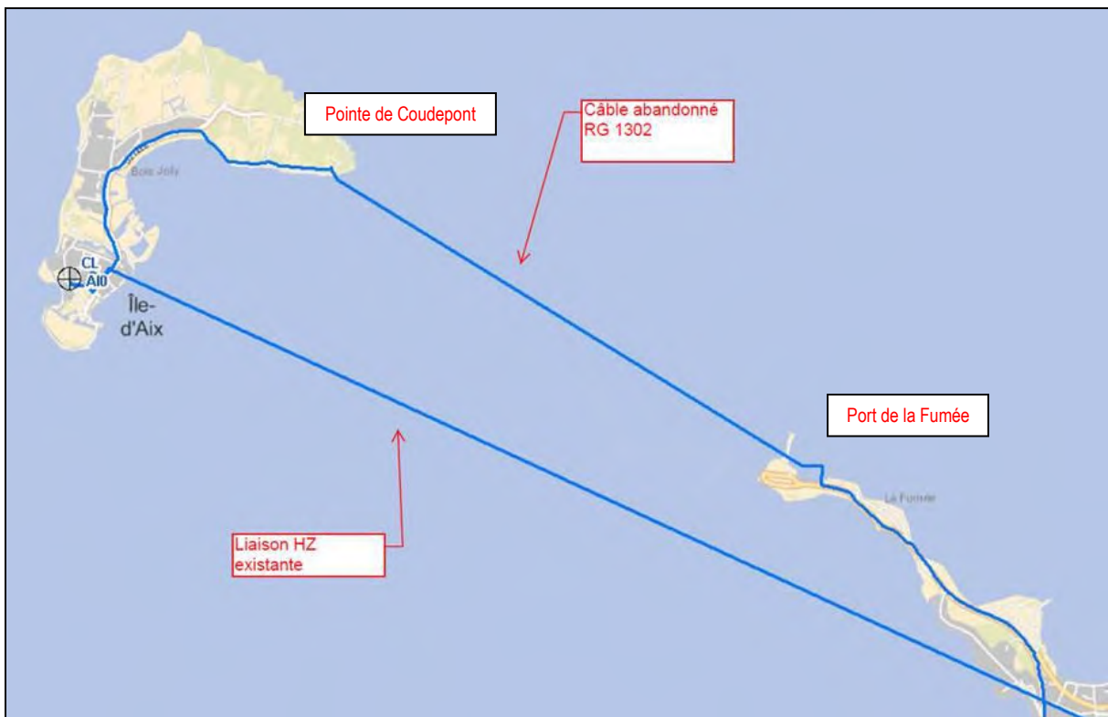
Figure 1 : Réseau de télécommunication entre Fouras et l'Île d'Aix
