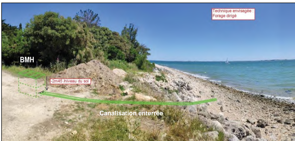
Figure 13 : Projet d'implantation et principe d'aménagement de la chambre de plage
