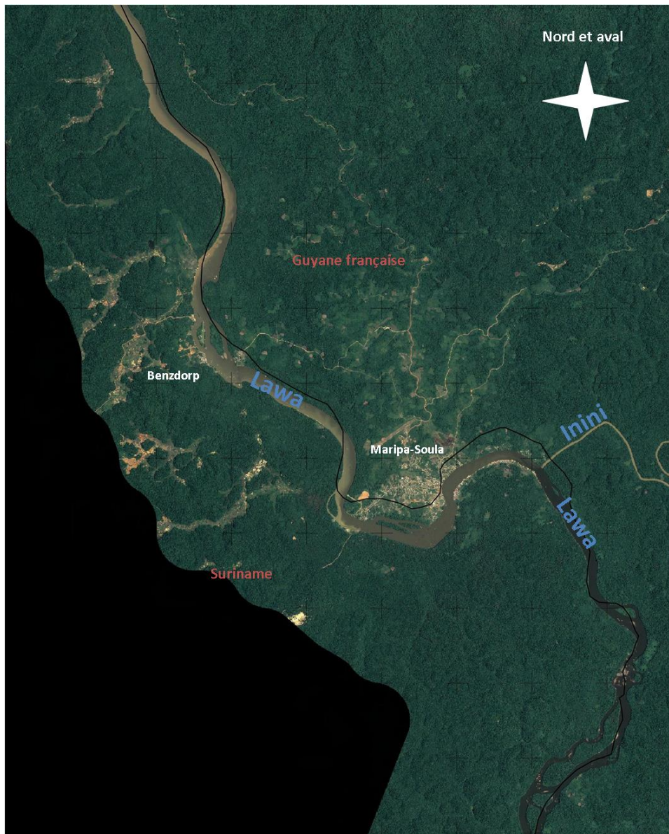
Figure 61. Image spot 6-septembre 2016. Turbidité de l'eau par les rejets d'orpaillage en amont et en aval de Maripa-Soula. On remarque les matières en suspension alimentées par l'Inini, puis par la crique en face de Maripa-Soula, enfin par l'exploitation à la hauteur de Benzdorp.
