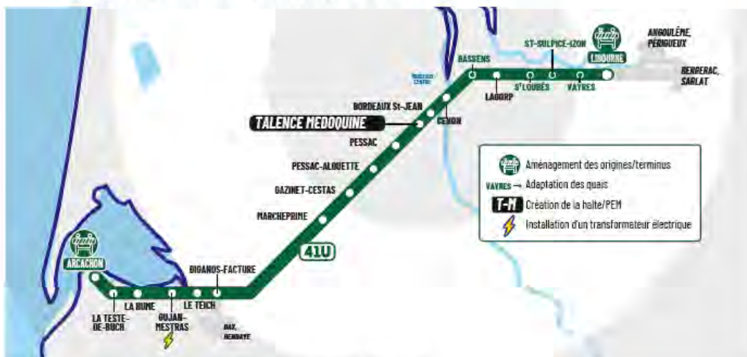
Principes des aménagements projetés sur l'axe Libourne-Arcachon
