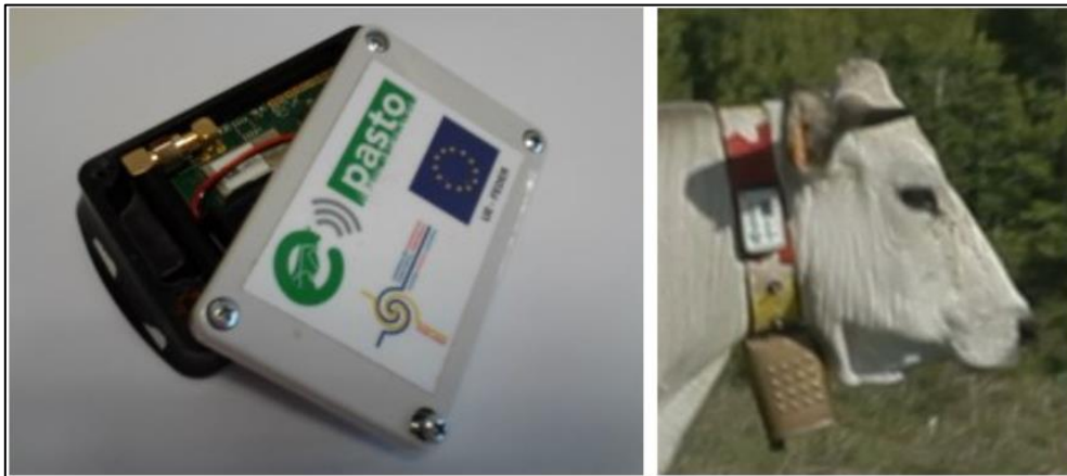
Figure 10: Illustration du collier connecté et de son positionnement sur le bovin – source : (Llaria, Terrasson, Arregui, & Hacala, 2015)
