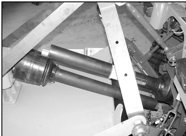
Figura 5. Le due metà di albero posizionate in parallelo
