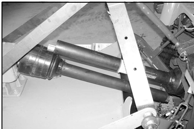
Figura 5. Mitades de la transmisión colocadas en paralelo
