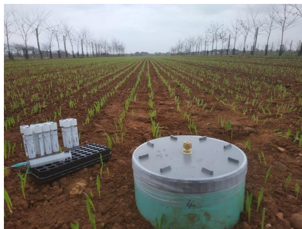
Fig. G-1 Dispositif expérimental de prélèvement d'échantillons de gaz à la seringue dans une chambre hermétique sur le site DIAMS dans le but de mesurer la concentration en N 2 O au cours de l'accumulation du gaz dans la chambre et calculer un flux d'émission.
