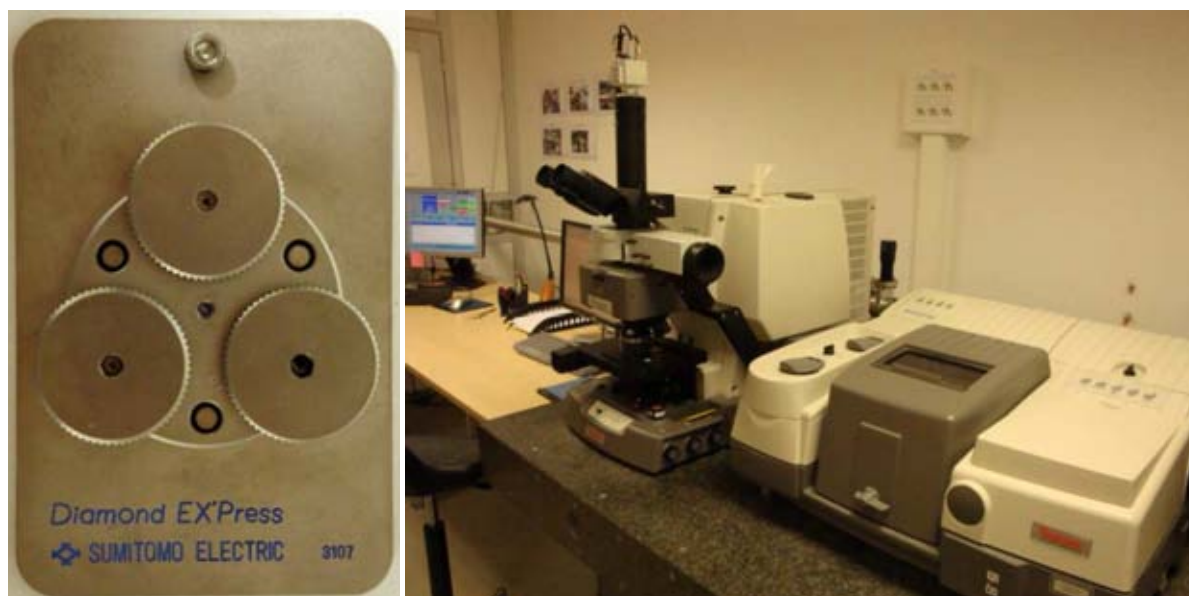
Fig. 114 – Dans la cellule de compression (à g.), l'échantillon est disposé entre deux diamants puis comprimé au moyen de vis. Le parallélisme strict des deux parties vissées est déterminant pour la réussite de l'expérimentation. © Fl. Berrouet.
