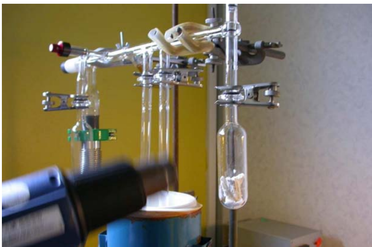
Séchage du porte-échantillon contenant les baguettes de mondmilch pour faciliter la sublimation de l'eau. © D. Genty
