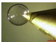
FIGURE 1.6 – Le cône implanté dans la cible, permet de guider l’impulsion et de générer le faisceau d’électrons au plus près du cœur dense.
