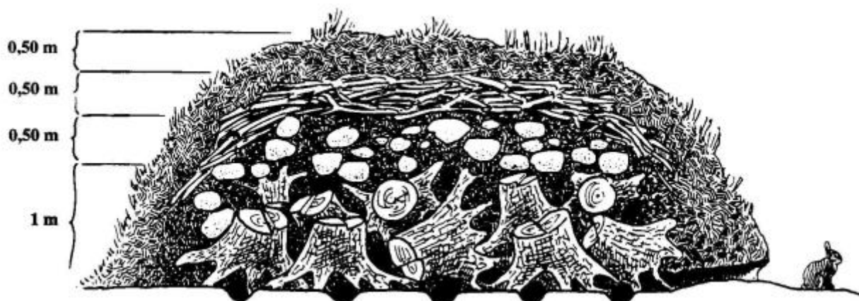
Figure 1 : Schéma d'une garenne artificielle à base de souches ou de grosses pierres (matériaux imputrescibles), recouvertes de terre végétale et de branchages. (dessin de M.-A. Aubineau)
