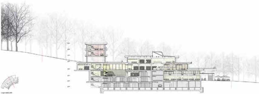
Section coupe transversale de la bibliothèque de la ville de Lausanne, montrant la structure en béton et les niveaux de la bibliothèque.
