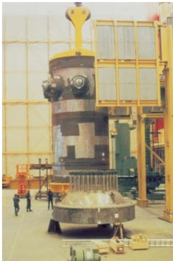
Les adaptateurs, soudés sur le couvercle de la cuve, accueillent les mécanismes de grappes et les colonnes de thermocouples
