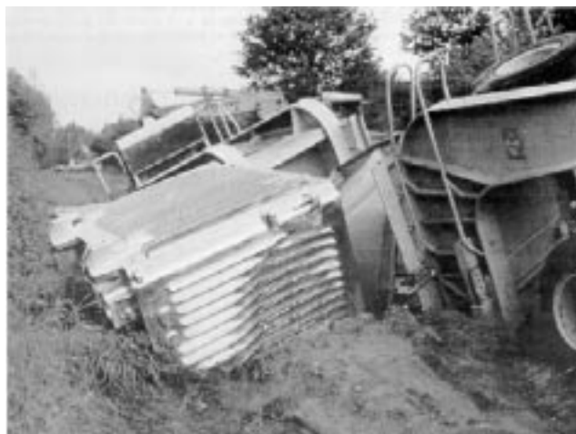
Emballage de transport d'éléments combustibles irradiés provenant de la centrale de Saint Laurent des Eaux-A (uranium naturel – graphite – gaz) après un accident de transport en 1987.
