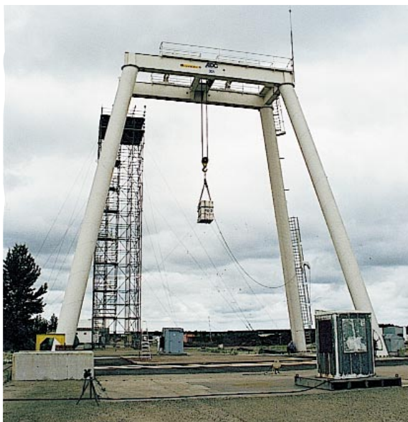
Essai de chute d'un emballage
