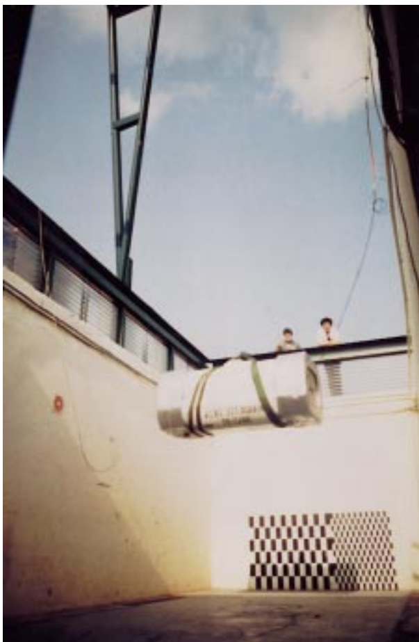
Chute d'un emballage sur un site d'essai
