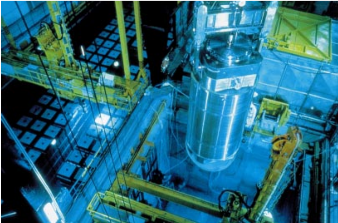
Déchargement sous eau de combustibles irradiés
