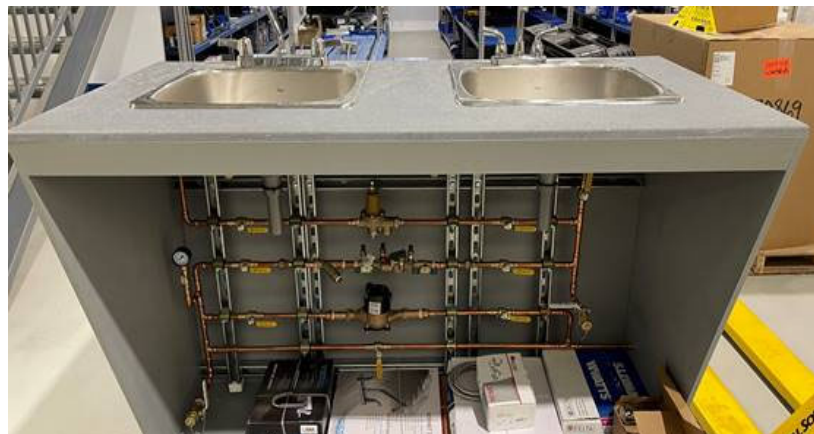
Figure 7 - Banc de test pour vérifier les niveaux de plomb libérés par les accessoires de plomberie installés dans les bâtiments municipaux
